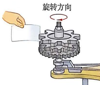
图 2-15 齿轮的齿数越多, 齿轮撞击纸片发声的音调越高
