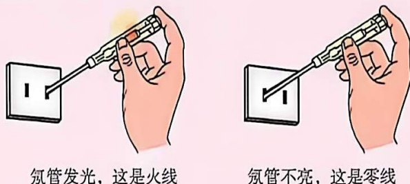
图 16-29 用测电笔辨别火线与零线
