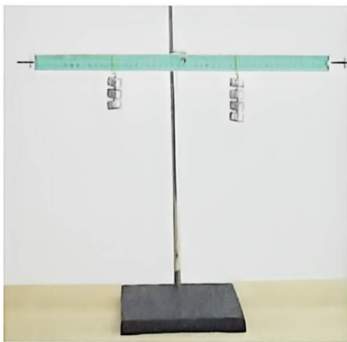
图 11-4 探究杠杆平衡条件的实验装置
