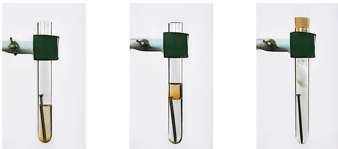
图 8-18 铁钉生锈条件的探究实验（放置一周后）
